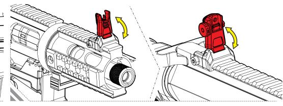
• PULL THE LEVER AND ROTATE TO RELEASE/LOCK BARREL
